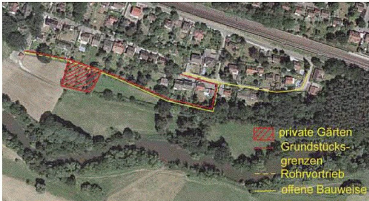
Luftbildaufnahme mit Darstellung der Grundstücksgrenzen und der Kanaltasse
