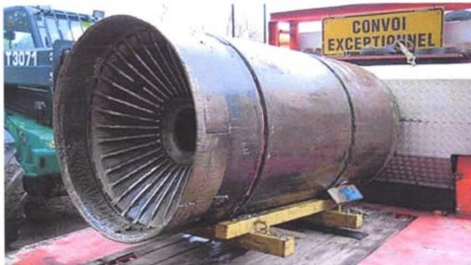
Bohrkopf DA 1.100 mm gesäubert und zum Abtransport verladen – das Schneidrad wurde demontiert, die aufgesetzten Stahlleisten in der Brecherkammer sind erkennbar
