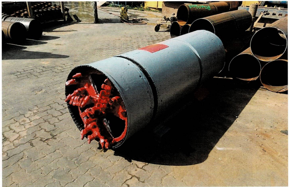
Die Vortriebsmaschine (Bohrkopf) wurde vor dem Einsatz in der Werkstatt geprüft und vorbereitet. Das Schneidrad mit den Abbaugeräten wurde auf den Boden abgestimmt.
