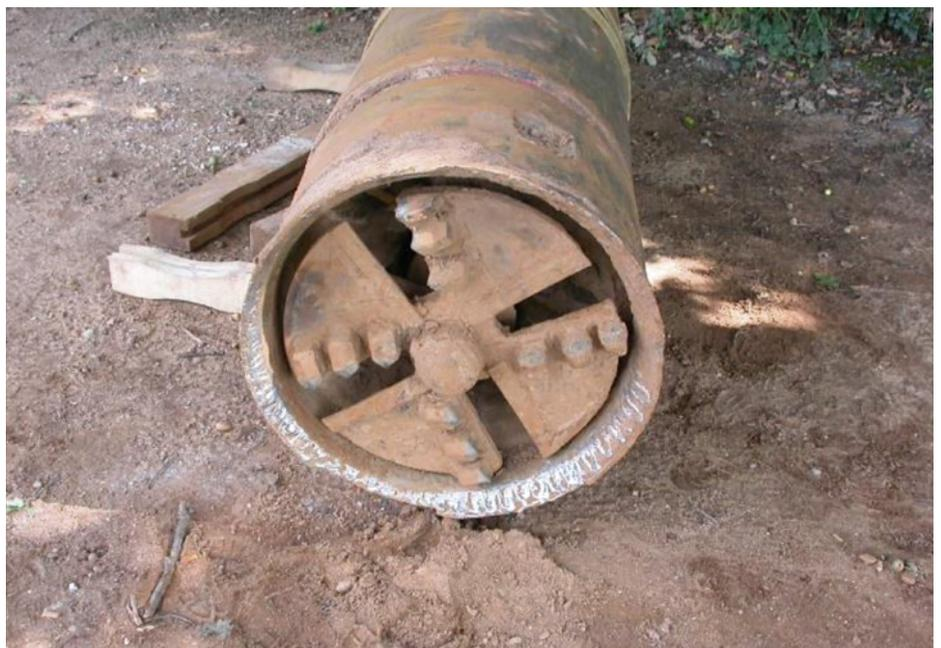
Blick von vorn auf den Bohrkopf mit dem Schneidrad, das mit Abbauwerkzeugen für bindige und nichtbindige Lockergesteine bestückt ist.
