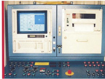
Steuerstand der Mikrotunnelanlage mit Schneckenförderung
