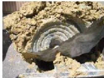
Ein gebogener Gesteinsbrocken, der ein Hindernis darstellte. Deutlich zu erkennen die Spuren der Abbaugeräte des Schneidrades.
